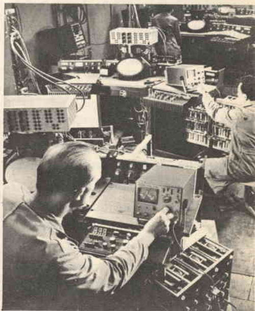
Impiego del nuovo oscilloscopio PM 3200 per controllare l'assemblaggio dei componenti in una linea di montaggio di microscopi elettronici. (documentazione Philips)
